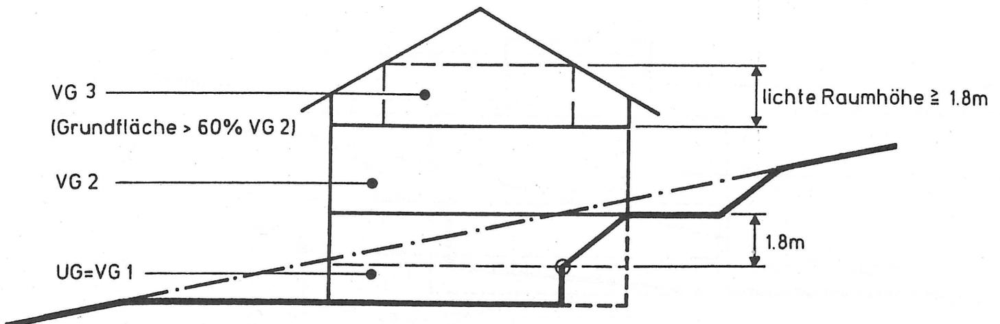
Untergeschosse gelten als Vollgeschosse, wenn mehr als 60% der Fassadenabwicklung um mehr als 1,8 m (bis Oberkante Geschossdecke gemessen) über das gewachsene Terrain herausragen. Liegt das gestaltete Terrain tiefer als das gewachsene, ist das gestaltete Terrain massgebend.
